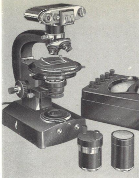
Bild 7. „MF“-Lupenaufnahmen 24mm x 36 mm am Mikroskop NidH4 unter Verwendung von „MF“-Bauteilen mit lichtelektrischer Messung der Belichtungszeit
