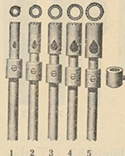
Fig. 223 - Riduttori al ruvido per radici. Servono vantaggiosamente per fare rugosità in tutta l'apertura della radice.
