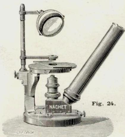
Plaque à chauffer, lentille condensatrice.
