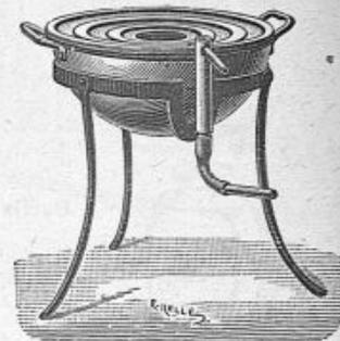
N° 40. Bain-marie forme bassin, en cuivre rouge, monté sur support avec rondelles concentriques disque percé de 4 trous, niveau constant cuivre.
