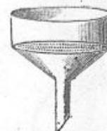
N° 749. Entonnoirs en porcelaine, de Buchner, pour filtrations par le vide, à parois droites et plaque filtrante percée de trous.
