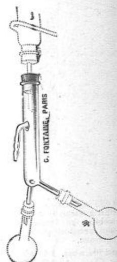
N° 651. Tube à deux branches pour distillation fractionnée.
