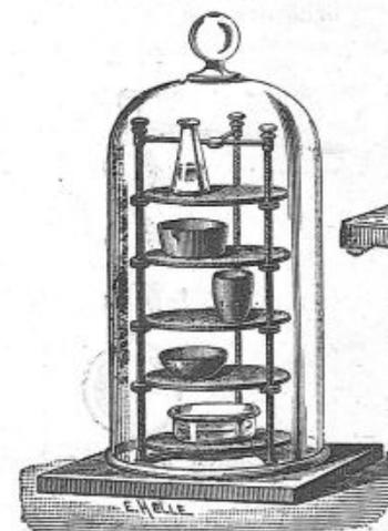
N° 604. Dessiccateur à étagère d'Esbach, comprenant : 1 cloche forme haute, rodée sur plan en glace dépolie, 1 étagère à hauteur variable, 5 disques en verre double et un cristalliseur. 150 »
