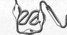
N° 1405. Tube laveur absorbant de Schloesing avec tube à chlorure de calcium. 18 50
