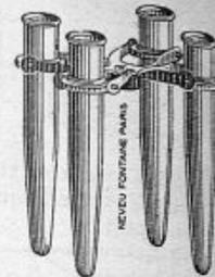
Tête de centrifugeur avec tubes en aluminium.
