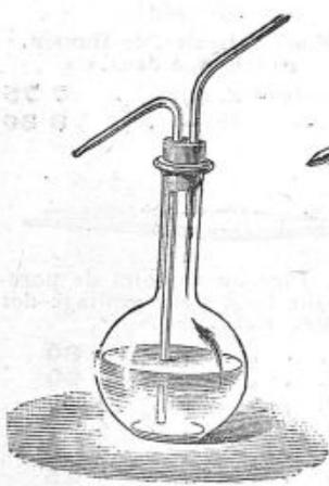
N° 1101. Pissette à eau froide, montée sur ballon avec bouchon caoutchouc.
