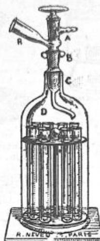
N° 617. Appareil R. Neveu, pour distillation fractionnée sous pression. L'appareil complet avec 8 tubes non gradués. . . . . 120 »
