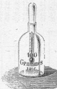
N° 90. Flacon à densité (Picnomètre) avec thermomètre intérieur.
