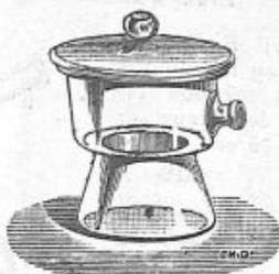
N° 597. Dessiccateur de Chancel, couvercle à bouton, avec tubulure sur le côté.
