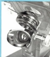
Kondensorträger, zweilinsiger Kondensor A = 1,20 und Mikroskopspiegel
