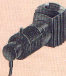
Niedervoltleuchte „Lux NC“; Lampenge- häuse mit Kollektor; Niedervolt-Glühbirne 15 Watt (6 Volt); Transformator mit Stufen- schalter; für Dunkelfeld- und Phasenkon- trast-Untersuchungen, für Mikroprojektion und Mikrophotographie
